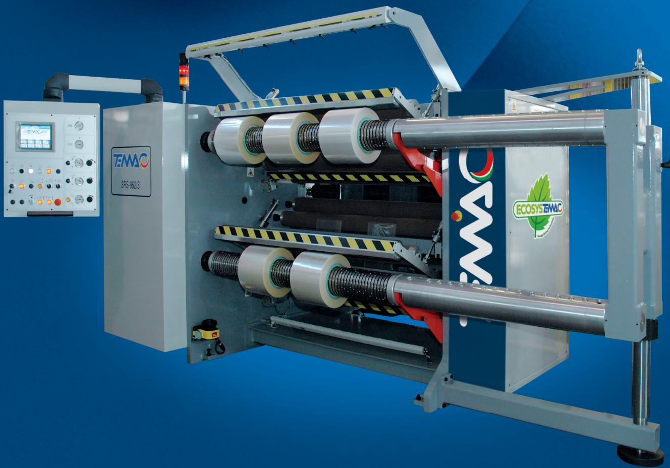
**La nuova serie SRS 962 unisce al design tradizionale il meglio della semplicità e flessibilità nell'utilizzo. Queste macchine sono in grado di lavorare film plastici, accoppiati, coestrusi, carta ed alluminio utilizzando un sistema di taglio a coltelli circolari a movimentazione pneumatica.**
